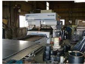
レーザーを使った鋼板切断機械
